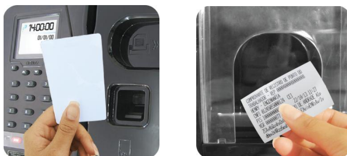
Figura 4 - Marcação de ponto via cartão proximidade RFID.
